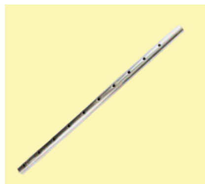
TELESCÓPICA/FLAUTA PARA ESCORA Diâmetro: Ø42,40 mm - Ø48,30 Dimensões: 1500 mm - 2000 mm - 3000 mm Parede: #2,65 mm - #3,00mm
